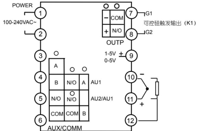
注1：线性电压量程在500mV以下的由10、11输入，0~5V及1~5V的信号由9、10端输入。
