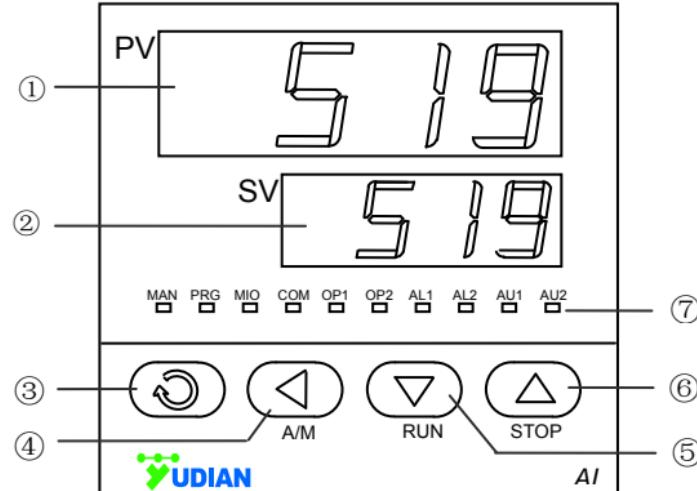
仪表上电后进入基本显示状态，此时仪表上显示窗显示测量值（PV）、下显示窗显示给定值（SV）或输出值。上显示窗交替显示“orAL”，表示输入的测量信号超出量程。下显示窗交替显示“HIAL”、“LoAL”、“HdAL”或“LdAL”时，分别表示发生了上限报警、下限报警、偏差上限报警、偏差下限报警，若有必要也可关闭这项报警字符闪动功能以避免过多的闪动（将AdIS参数设置为oFF），若显示“EErr”则表示内部系统自检出错，应寄回返修。
